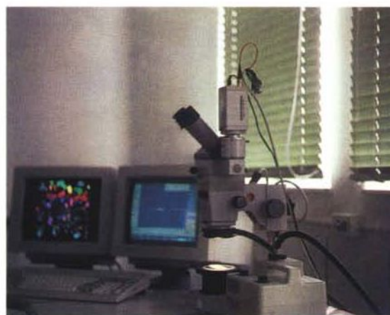
Le apparecchiature utilizzate nella fase di acquisizione delle immagini. Questo gruppo di strumenti, che fa parte del sistema VIDAS, è costituito da uno stereomicroscopio ingranditore, da una videocamera CCD e da un gruppo illuminatore a fibre ottiche.
